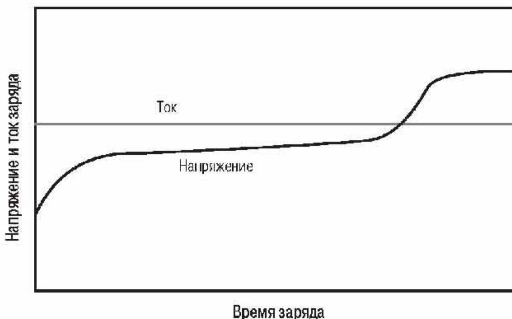
Рис. 4 График заряда постоянным током.
