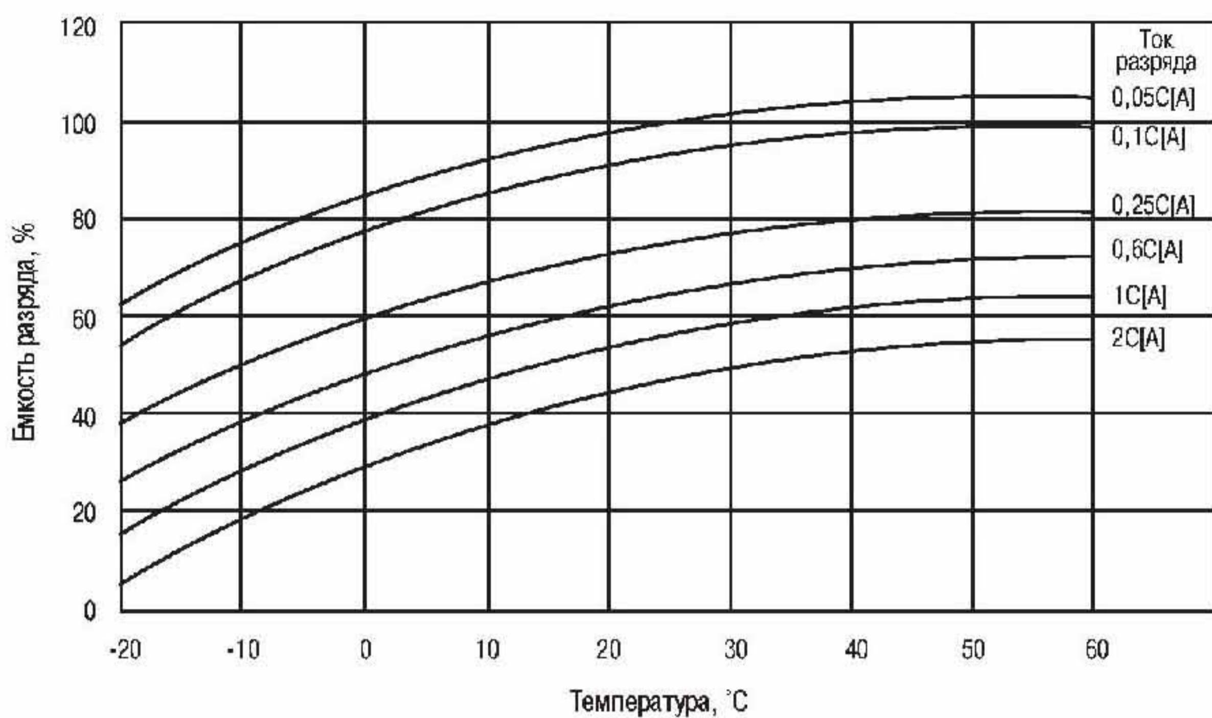
**Рис. 9 Влияние температуры на емкость аккумулятора**
