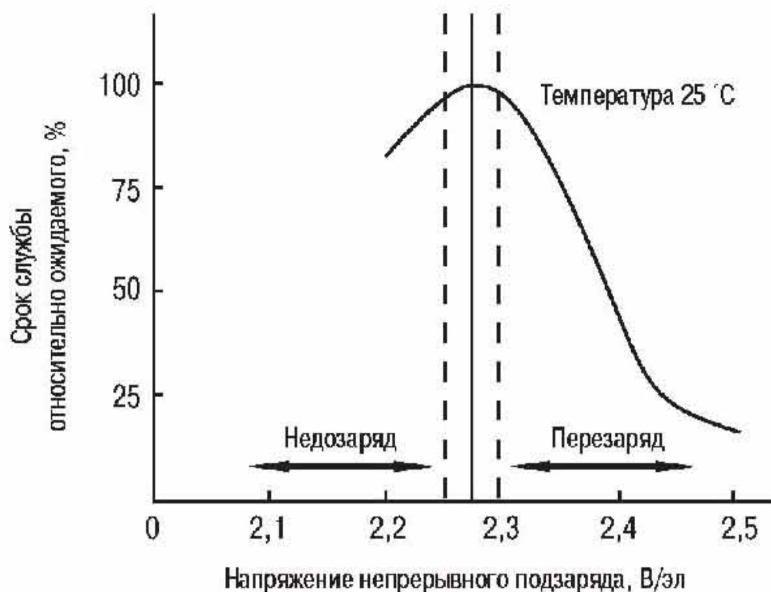
Рис. 14 Зависимость срока службы аккумулятора от напряжения подзаряда.
