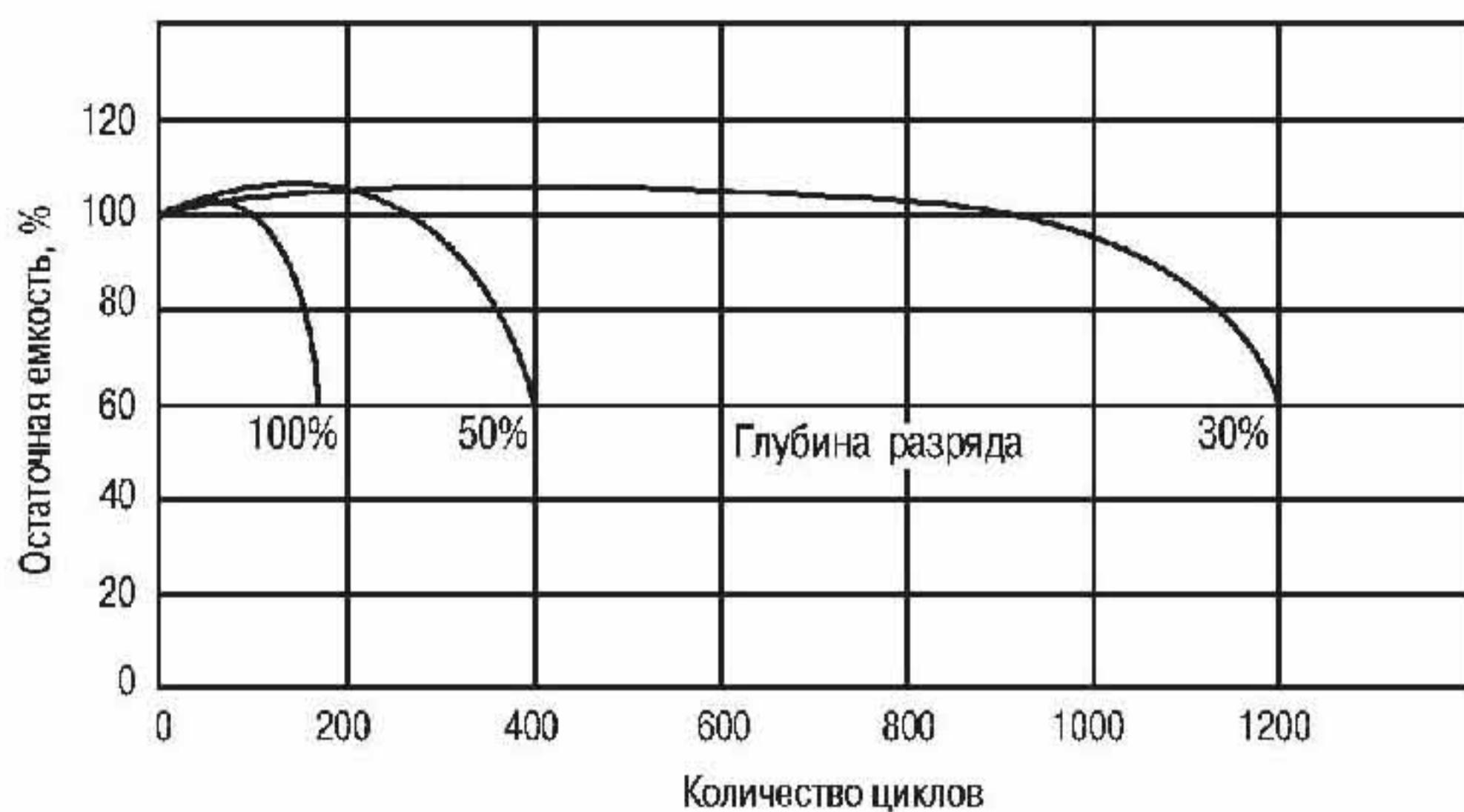
Рис. 12 Зависимость количества циклов от глубины разряда
