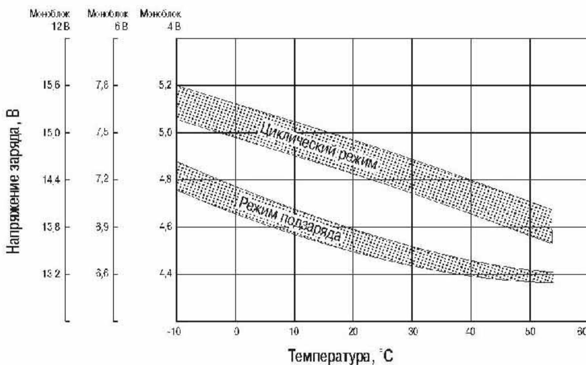
**Рис. 11 Соотношение между напряжением заряда и температурой.**
