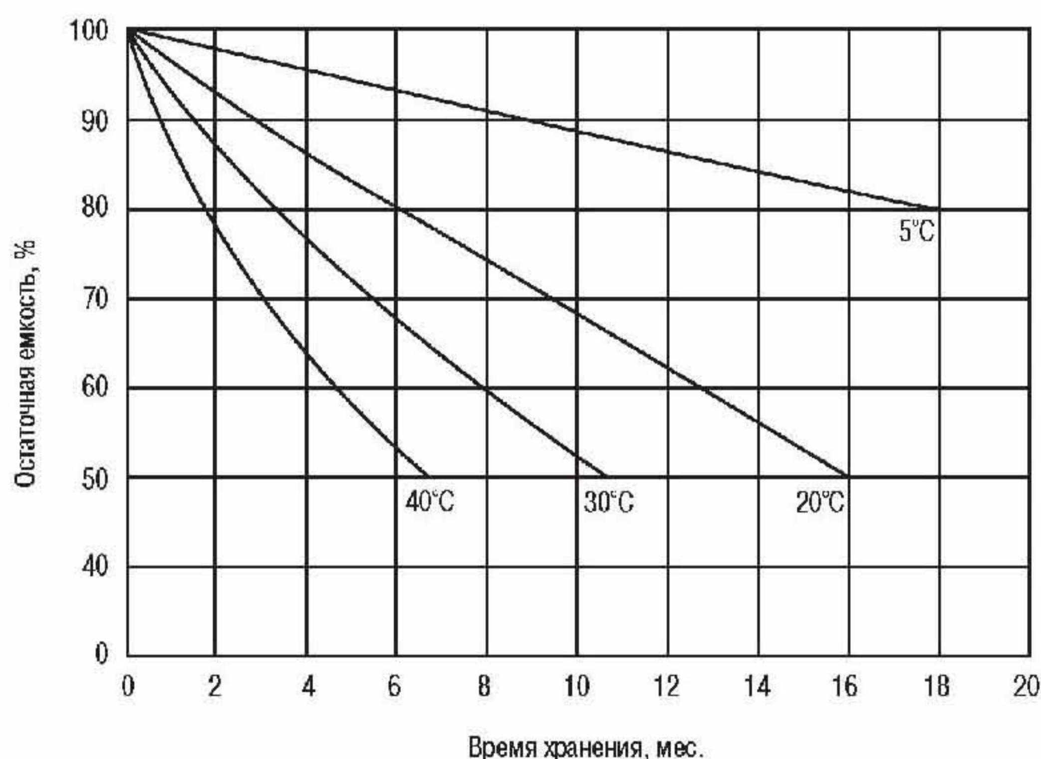
Рис. 1 Характеристики саморазряда аккумулятора.
