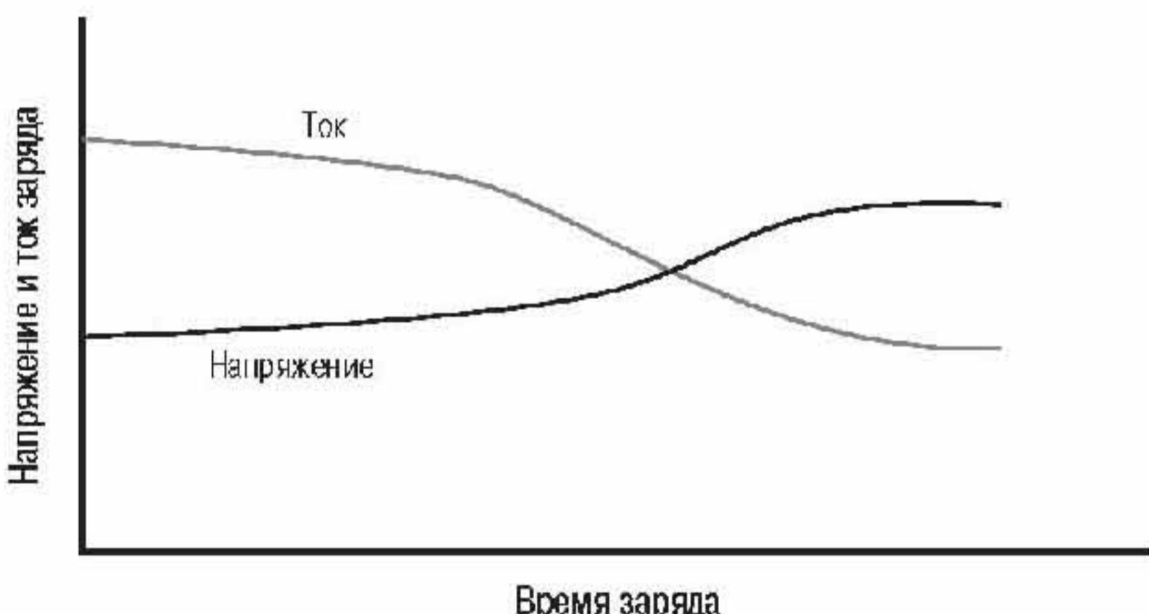
Рис. 5 График заряда падающим током
